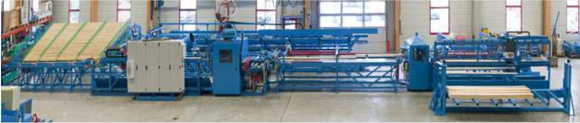
Die Profil-Holz-Elemente aus der Kategorie Brettstapelelemente werden mit einer eigens dafür entwickelten Anlage, der sogenannten PHE-Fertigungslinie, in Sägewerken, Zimmereibetrieben oder anderen Holzbearbeitungsbetrieben hergestellt.
