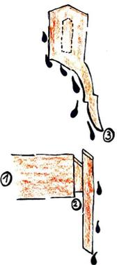
Um Balkenköpfe vor der natürlichen Verwitterung und der frühzeitigen Zerstörung zu schützen, wurden aus alter Zeit heraus, >Opferhölzer< entwickelt. Längsholzteile, die das Hirnholz des Balkens vor der natürlichen Zerstörung schützen. Wenn diese Opferhölzer kaputt gehen, werden Sie mit geringem Kostenaufwand ersetzt. Der Sparrenkopf allerdings bleibt >gesund< und Schadensfrei.
