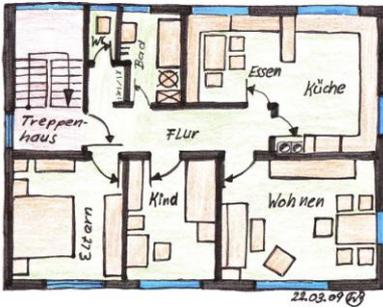
Ein klassischer Grundrissplan von einem Reisbrett aus gemacht. Die bisherige Zeichenweise. Mit einem CAD Programm, werden solche Pläne mit eingaben von Längen und Breitenmaßen von einem Computerprogramm erstellt.
