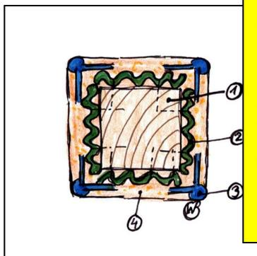
Aus der Geschichte heraus, wurden meist unterschiedliche Baumaterialien bis hin zu Holz verputzt. Aus diesem Grunde wurde dem Putz ein Trägermaterial vorgegeben. Diese Bleche, die wir dazu verwenden, nennen wir Streckbleche. Um jetzt diese Streckbleche an den Kanten mit dem Putz zu einer klaren Linie zu führen, wurden Eckschutzschiene mit integriert. Grün sehen wir die Streckbleche. Blau sehen wir die Eckschienen.
