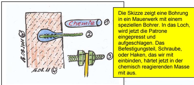
Die Skizze zeigt eine Bohrung in ein Mauerwerk mit einem speziellen Bohrer. In das Loch, wird jetzt die Patrone eingepresst und aufgeschlagen. Das Befestigungsteil, Schraube, oder Haken, das wir mit einbinden, härtet jetzt in der chemisch reagierenden Masse mit aus.
