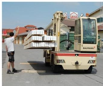
**Der Gabelstapler** ist ein bewegliches Fahrzeug mit Rädern, das schwere Lasten vom Boden in die Höhe befördern kann oder Umgekehrt.
