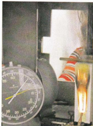
Bild 3 Flammenhöhe nach 12 Sekunden
