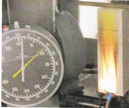
Bild 1 Flammenhöhe nach 9 Sekunden
