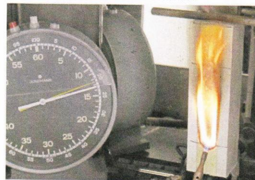
Bild 4 Flammenhöhe nach 12 Sekunden
