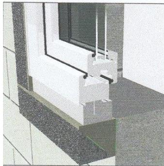
**Fenstereinbau in einer Dämmebene:**
